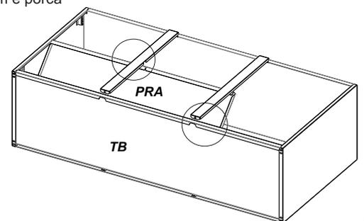
8° Encaixe as travas para calço clic nas laterais e coluna.
