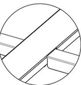
7° Com a prateleira (PRA) enclinada encaixe-a nas colunas e nas laterais (LA); após encaixada parafuse-a nas costas (FU).
