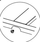
6° Fixe as colunas no tampo (TB) e na base (TB) com parafuso M4x6mm e porca M4.
