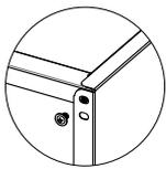
4° Encaixe a lateral (LA) na base (TB), (já posicionada sobre as costas) fixe com parafuso M4x6mm e porca M4.
